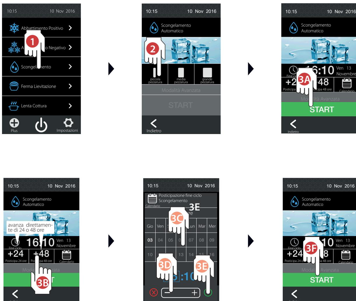
**Fermalievitazione - Automatic Leavening Retarder - Fermentation Contrôlée automatique - Automatische Gärunterbrechung - Fermentación controlada automática - Отложенная расстойка**
