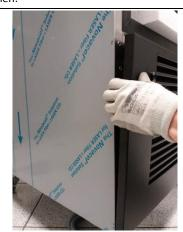
16. Den Deckel der elektrischen Verteilerdose entfernen.
