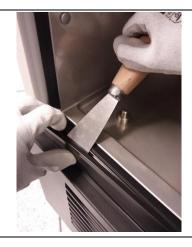
4. Dann den Deckel mit beiden Händen halten und zu sich ziehen, um ihn vollständig zu entfernen. Bei den anderen Seiten in derselben Weise verfahren; bei Auswechslung der Rahmenheizung mit dem nächsten Punkt weiterverfahren, andernfalls direkt zum Punkt 21 übergehen.
