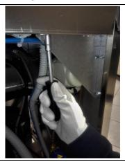
12. Den Isolierschaum entfernen, um die Kabel freizulegen.
