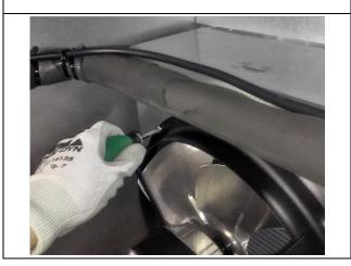
**7.** Die zwei gerändelten Knöpfe an den Enden der unteren Vorderseite lösen.
