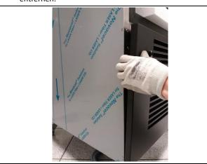
**3.** Die Knöpfe, die das Haltegitter des Filtertuchs fixieren, lösen.
