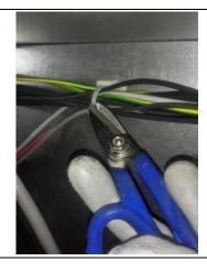
**12.** Das Fühlerkabel nach unten ziehen und darauf achten, es so weit wie möglich senkrecht zum Kammerboden auszurichten.
