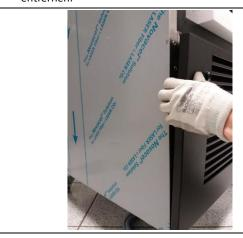
10. Den Deckel der elektrischen Verteilerdose entfernen.
