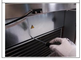
6. Die Platine entfernen und ersetzen, dazu auf die Kunststoff-Befestigungsrevolver einwirken; alle Klemmen in der entsprechenden Reihenfolge wieder anschließen [siehe Schaltplan Abschnitt 10] und schließlich alle zuvor entfernten Abdeckungen und Schutzvorrichtungen wieder schließen.
