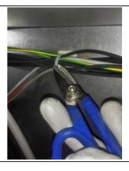
12. Das Leitungen derHeizung nach unten ziehen und darauf achten, es so weit wie möglich senkrecht zum Kammerboden auszurichten.
