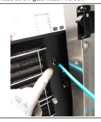
**17.** Der Fühler "B1" von den Klemmen 45 und 46 Der Leistungsplatine abtrennen.
