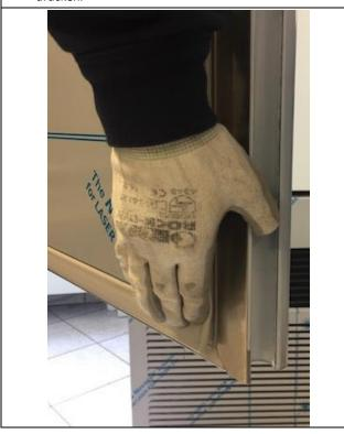
3. Anschließend sicherstellen, dass die Dichtung gleichmäßig an den Rahmendeckeln anliegt und so eine perfekte Dichtigkeit gewährleistet.
