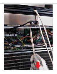
**14.** Die annäherd richtige Position wird erreicht, wenn sich die beiden schwarzen Zeichen in unmittelbarer Nähe der Durchgangsbohrung befinden.
