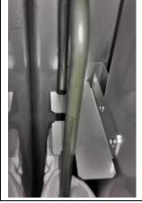
**14.** Mit einer verstellbaren Zange die Spannfeder der Heizung wieder einfügen.
