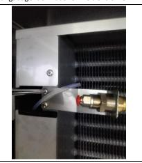
3. Die Düse vom Fitting lösen.
