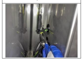
**6.** Die Heizung nach oben ziehen und auf diese Weise entfernen.
