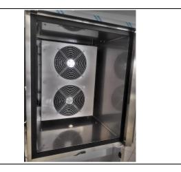
**2.** Den Förderer des Verdampfers durch Abschrauben der entsprechenden Befestigungsschrauben öffnen.
