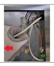
10. Um die richtige Länge des Fühlerkabels außerhalb der Tür zu haben, wie in der Abbildung gezeigt vorgehen und dann die Drähte in der richtigen Reihenfolge wieder an die Klemmenleiste anschließen.
