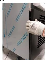
4. Den Deckel der elektrischen Verteilerdose entfernen.
