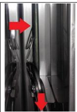
**15.** Die zwei gerändelten Knöpfe an den Enden der unteren Vorderseite lösen.
