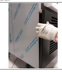
18. Den Deckel der elektrischen Verteilerdose entfernen.
