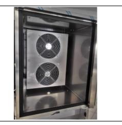
**2.** Den Förderer des Verdampfers durch Abschrauben der entsprechenden Befestigungsschrauben öffnen.
