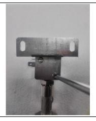
**5.** Das Magnetventil an der Einheit auswechseln, und die Verbindungen sorgfältig versiegeln.
