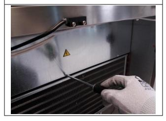
17. Der Fühler "B2" von den Klemmen 47 und 48 der Leistungsplatine abtrennen [siehe elektrischen Schaltplan Abschnitt10].
