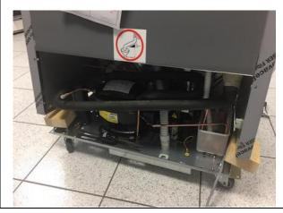
Die Abflussrohre verschieben, um den Zugriff auf den Verflüssiger zu erleichtern.
