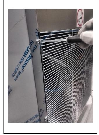
2. Nur beim Modell mit 5 Blechen werden die hinteren Schrauben entfernt und die vorderen Schrauben gelöst, um die Drehung des Chassis zu ermöglichen. Dieses darf nicht mehr als 50 mm angehoben werden und die Türöffnung muss vor dem Kippen blockiert werden.
