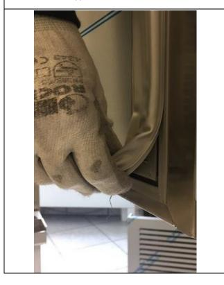
Die neue Dichtung positionieren, diese dazu zuerst an den 4 Ecken einsetzen und dann entlang der jeweiligen Seiten drücken.
