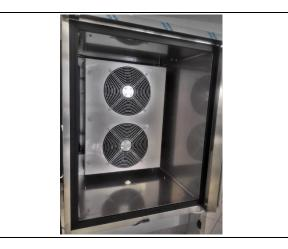
**2.** Den Förderer des Verdampfers durch Abschrauben der entsprechenden Befestigungsschrauben öffnen.
