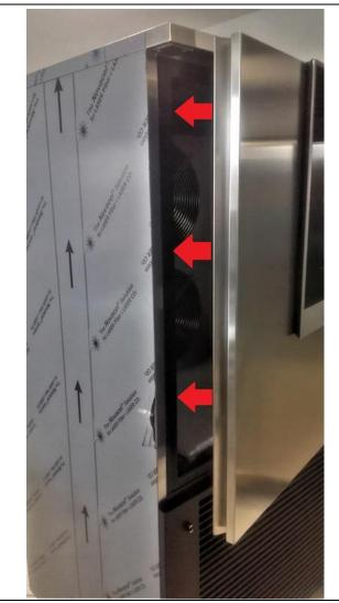
8. Die Tür kann durch die Verschiebung der Halterungsplatte in die erforderliche Position zum Rahmen herangerückt oder vom Rahmen entfernt werden.
