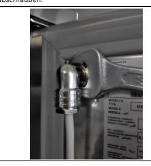
**4.** Das abgeschnittene Kabel mit dem der neuen Sonde verbinden, um es als Führung zu verwenden.
