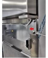
**2.** Die Frontplatte durch Ziehen an der Oberseite zu sich hin entfernen.
