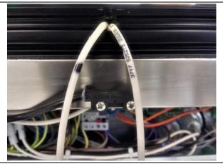
**15.** Die neue Heizung entlang des gesamten Rahmenumfangs vorsichtig in der entsprechenden Rille positionieren.
