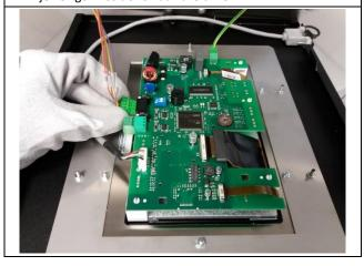
**6.** Die Muttern, die den Rahmen der Bedientafel fixieren, lösen.
