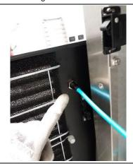
**9.** Die Schellen zur Befestigung der Rahmenheizung abschneiden.
