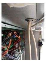
**17.** Die Drähte der Heizung durch die entsprechende Bohrung der Kabelverschraubungen führen.
