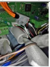
**20.** Das Versorgungskabel des neuen Lüfters am Klemmenbrett anschließen.
