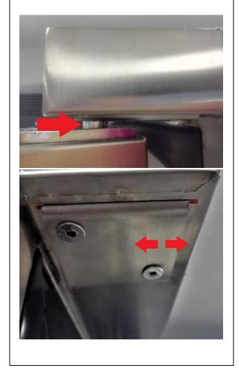
9. Nach Abschluss des Verfahrens einen zeitgesteuerten Zyklus bei einer Temperatur von -18°C starten und sicherstellen, dass die Dichtung den gesamten Rahmenumfang gleichmäßig abdichtet.
