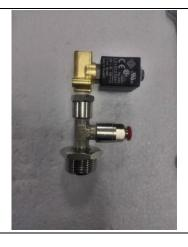
**6.** Die Ventileinheit auf dem entsprechenden Bügel positionieren und dann die gesamte Baugruppe auf dem Gerät montieren.
