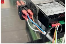
1 Öffnen Sie die Maschinenteiltür und2 ziehen die Anschlussleitungen vom Schalter ab
